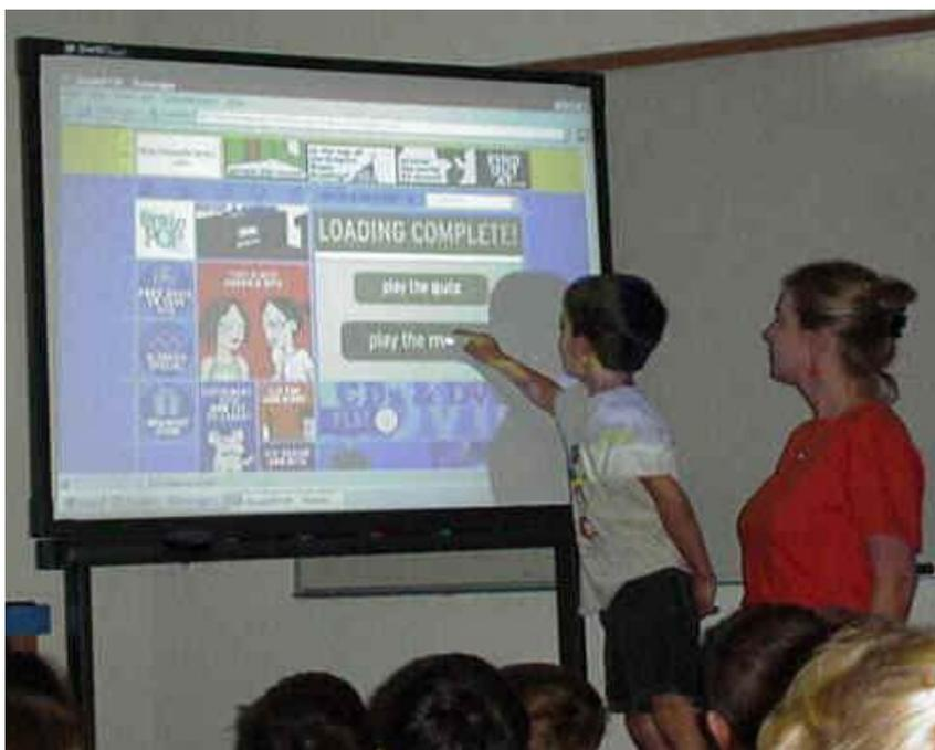
De esta forma, si tocamos con el dedo la pantalla y mantenemos los lápices en el lapicero, se activará el modo ratón, cambiando los modos del sistema de forma automática y transparente para el usuario. Sin embargo, hay un comando de menú para sustituir los lápices si es que queremos dibujar con el dedo. Por todo esto, podemos decir que la gran simplicidad de uso de esta pizarra interactiva es su mayor valía.
