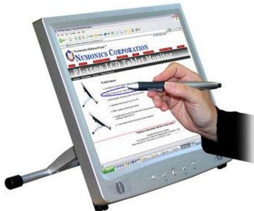
Se trata de un monitor táctil con software específico que se puede conectar a cualquier ordenador para manejar este y hacer anotaciones
