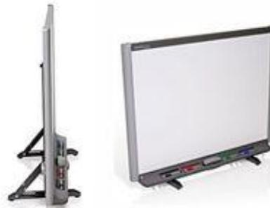
El panel de la pizarra está formado por dos capas separadas, la exterior es deformable al tacto. La presión aplicada facilita el contacto entre las láminas exteriores y interiores, provocando una variación de la resistencia eléctrica y nos permite localizar el punto señalado. Esta tecnología es utilizada por TeamBoard, Polyvision y Smart Board.
