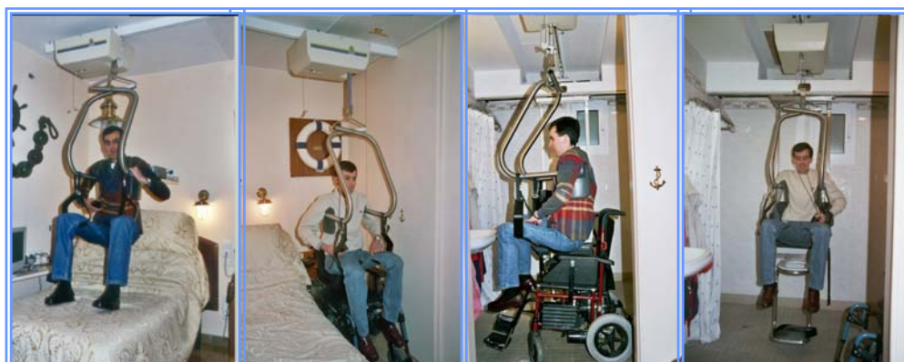
Fig. 1 - Secuencia de imágenes de Joaquín Romero usando una grúa de raíl
