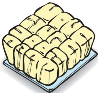
Cojín formado por celdas independientes que se inflan mediante una bomba manual.
