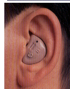
Figura 3. Audífono intracanal ubicado en la concha.
