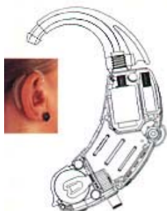
Figura 1. Imagen transversal de un audífono retroauricular
